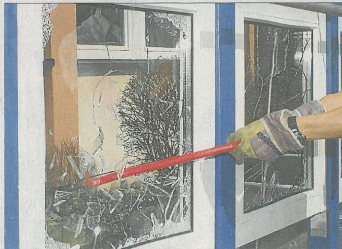
Fenster ohne Einbruchschutz (links) sind mit einem Schlag zerstört und bieten keinen Schutz. Sicherheitsfenster (rechts) widerstehen Einbrechern mehrere Minuten – eine Zeit, in der der Einbrecher seinen Versuch meist abbricht.
