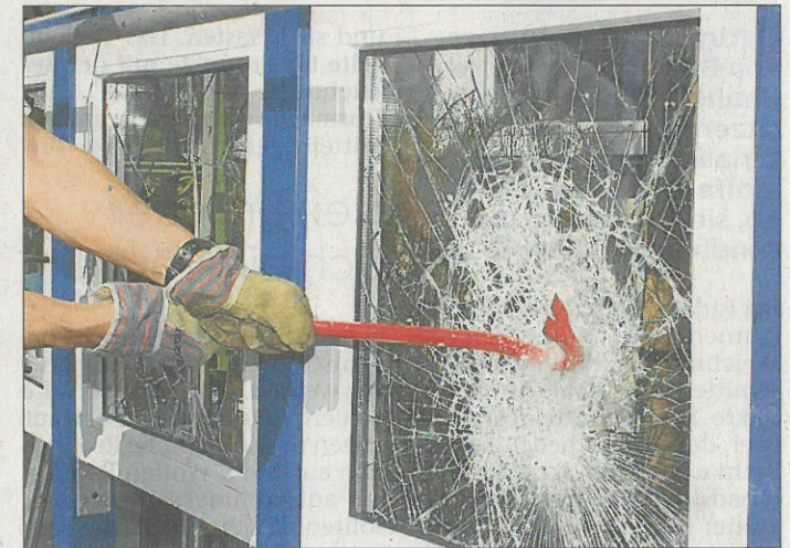
Fenster ohne Einbruchschutz (links) sind mit einem Schlag zerstört und bieten keinen Schutz. Sicherheitsfenster (rechts) widerstehen Einbrechern mehrere Minuten – eine Zeit, in der der Einbrecher seinen Versuch meist abbricht.
